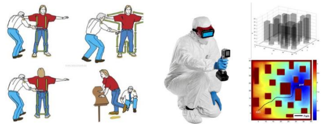
Figura 3. Inspección robotizada de trajes (figuras de derecha a izquierda): a) procedimiento de inspección aeroportuaria manual, b) operador con el equipo de inspección de UV, y c) cálculo de trayectorias libres de colisión utilizando el algoritmo Fast-Marching 2 modificado en un entorno 3D.
